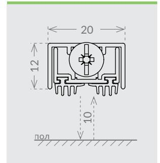
Уплотнитель из огнезащитного моно-экструдированного термопласта.
