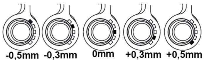
Последовательность регулировки петли по горизонтали
