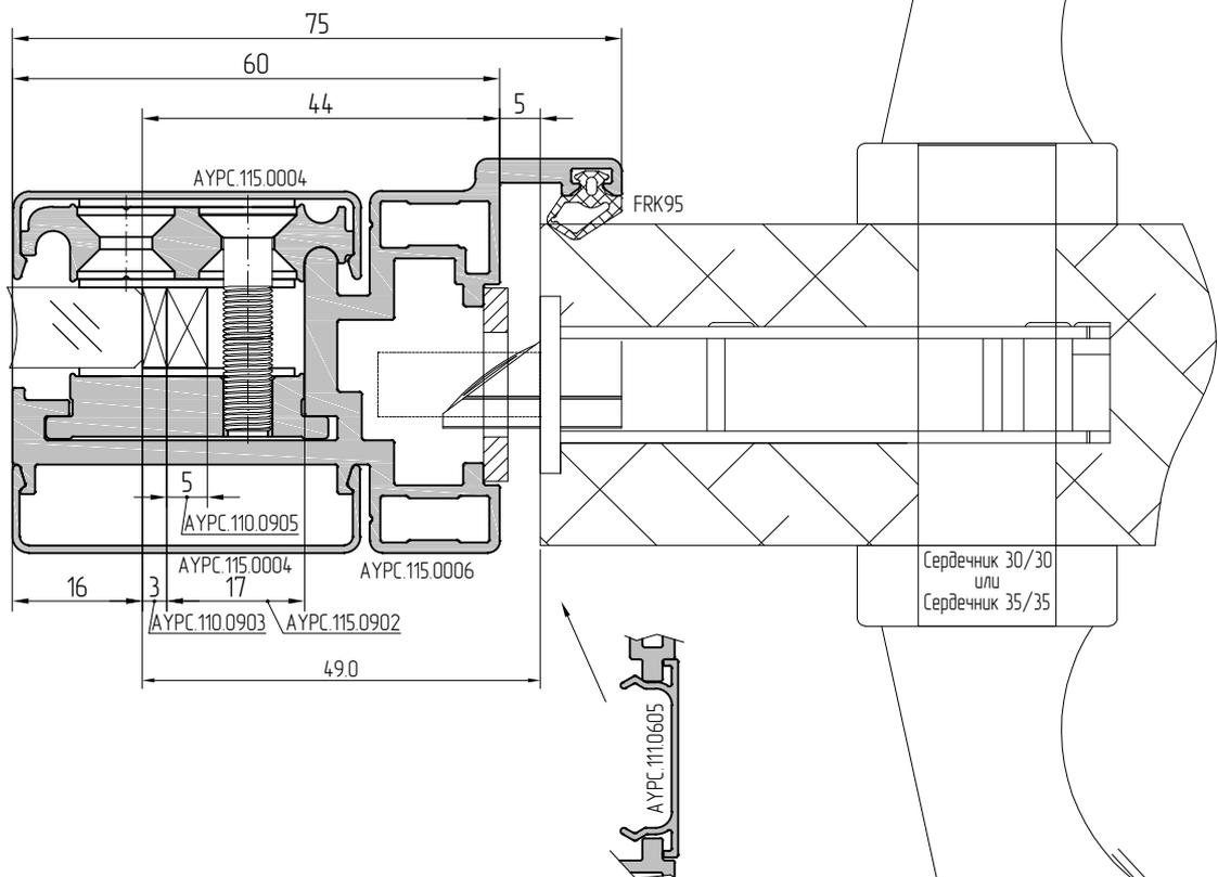
Примечание: замок выбирается в зависимости от используемого нажимного гарнитура или ручки.
